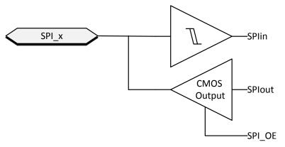
Figure 24. SPI buffer
