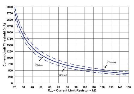
Figure 18. Current-Limit Threshold vs. R<sub>ILIM</sub>
