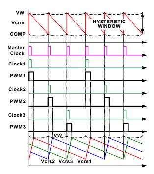
FIGURE 5. R3™ MODULATOR OPERATION PRINCIPLES IN STEADY STATE
