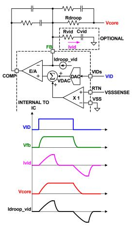
FIGURE 28. SLEW RATE COMPENSATION CIRCUIT FOR VID TRANSITION
