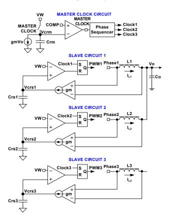
FIGURE 4. R<sup>3TM</sup> MODULATOR CIRCUIT
