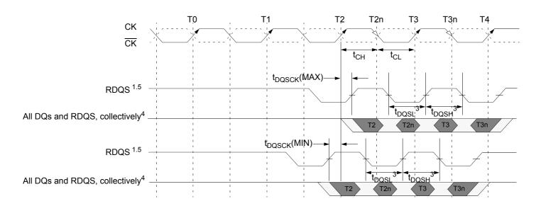
$\textbf{NOTE}: \ 1. \ t_{\text{DQSQ}} \ \text{represents the skew between the 8 DQ lines and the respective RDQS pin.}$
