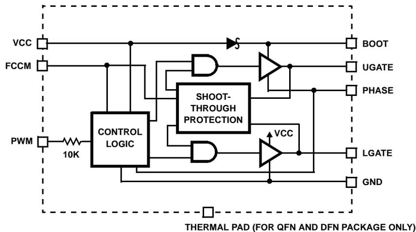
FIGURE 1. BLOCK DIAGRAM
