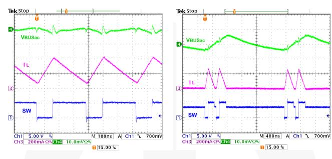
Figure 27. Boost PWM Waveform
