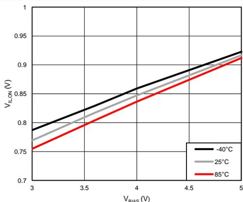
$V_{IN} = V_{BIAS} - 2\text{ V}$
