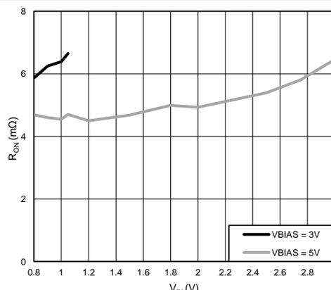
$T_A = 25^\circ\text{C}$        $V_{ON} = 5\text{ V}$        $I_{OUT} = -200\text{ mA}$
