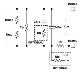
FIGURE 23. OPTIONAL CIRCUITS FOR RING BACK REDUCTION
