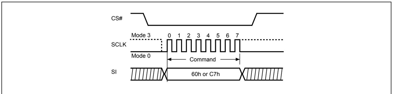
**Figure 45. Chip Erase (CE) Sequence (QPI Mode)**
