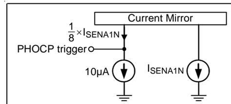
Figure 20. VDDNB Controller : Per-Phase OCP Setting
