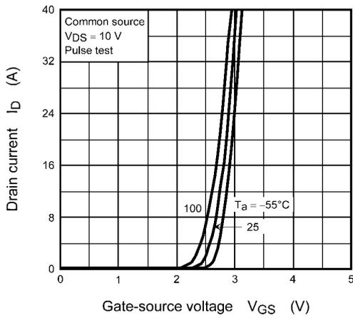
**Fig. 8.3  $I_D - V_{GS}$**
