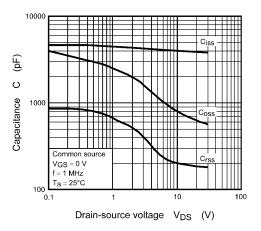
Fig. 8.8 Capacitance - V<sub>DS</sub>
