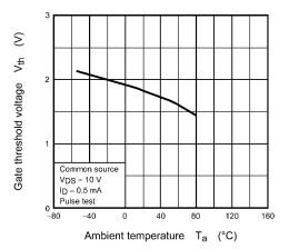
Fig. 8.9 V<sub>th</sub> - T<sub>a</sub>
