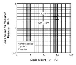
Fig. 8.5 R<sub>DS(ON)</sub> - I<sub>D</sub>
