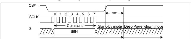
Figure 24. Deep Power-Down Sequence Diagram
