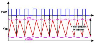
FIGURE 26. R3 MODULATOR OPERATION PRINCIPLES IN STEADY STATE
