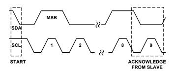
FIGURE 23. ACKNOWLEDGE ON THE SMBus
