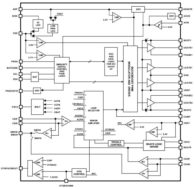
FIGURE 2. BLOCK DIAGRAM
