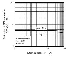
Fig. 8.5 R<sub>DS(ON)</sub> - I<sub>D</sub>
