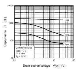
Fig. 8.8 Capacitance - V<sub>DS</sub>
